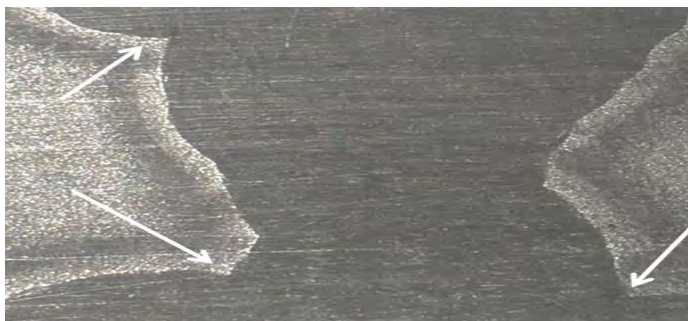
Рисунок 2 - Зоны концентраторы напряжений на линии сплавления
