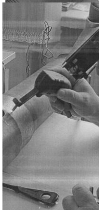
Рисунок 2 – Нанесение покрытия на шейку вала с использованием установки ЭЛИТРОН-22
